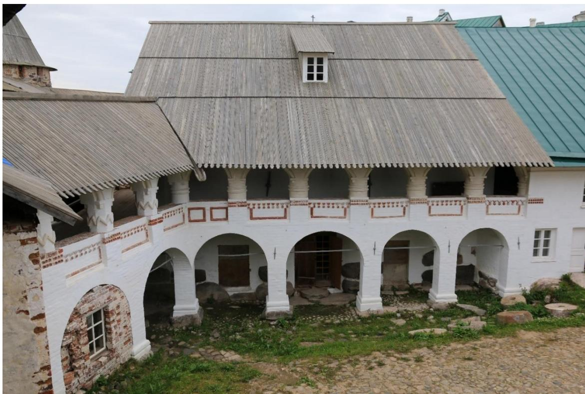
*Фото 21. Монастырская мельница. Расположена внутри стен рядом с Сушилом. Под мельницей проходит специальный канал от Святого озера к бухте Благополучия для вращения с помощью воды мельничных жерновов (некоторые из них видны на фотографии).*
